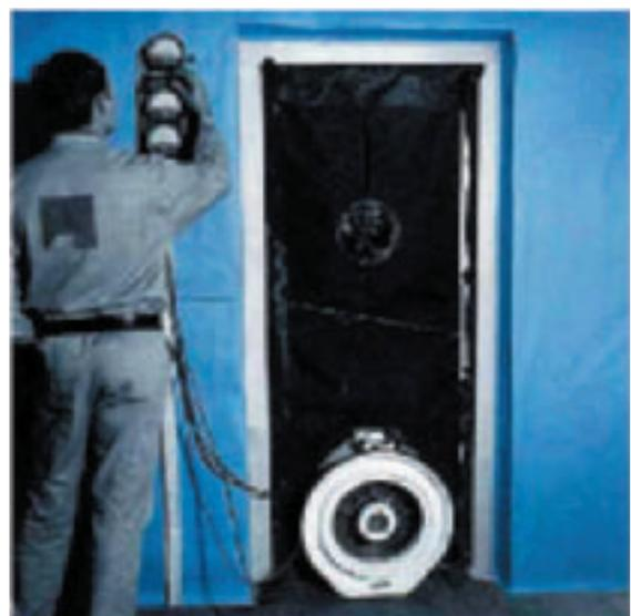
Foto eines Blower-Door-Testes
